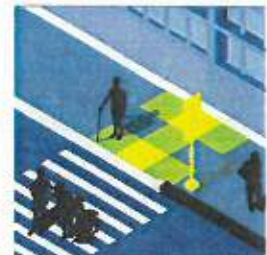
4b Asigurarea accesibilității spațiilor pietonale pentru persoane cu dizabilități (rampa, ghidaj în paviment etc.)
